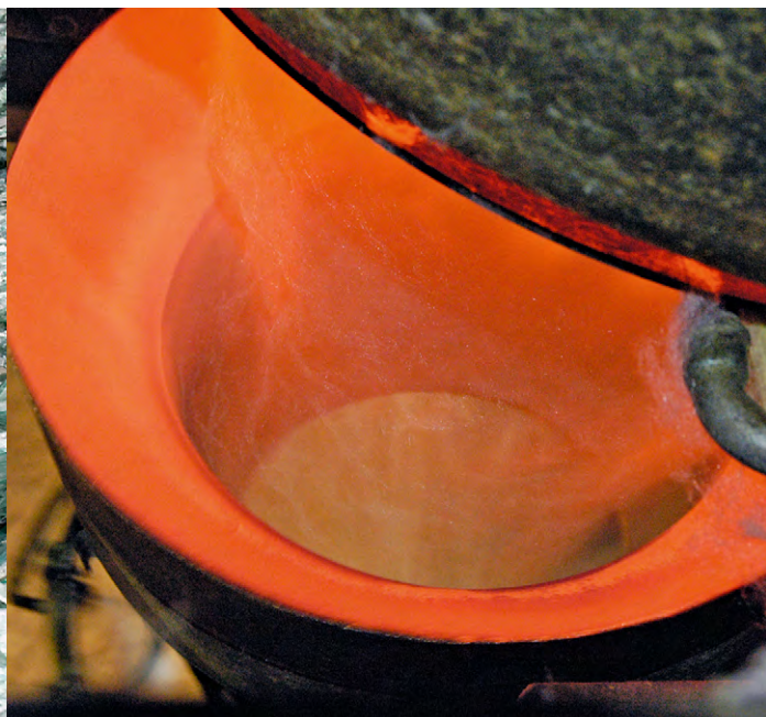
Fabrication de laine de verre ISOVER – défilage
