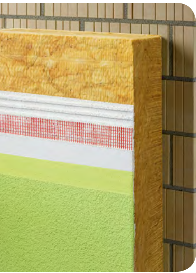
Mineralische, nicht brennbare, leichte Dämmplatte aus Glaswolle.
