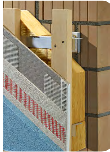
Die vorgehängte hinterlüftete Fassade mit Trägerplatte aus Recycling-Altglas.
